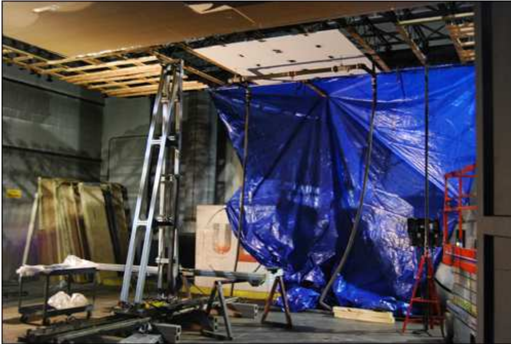
Figura 1. Complejo de prueba de tamaño de gotas de UL
